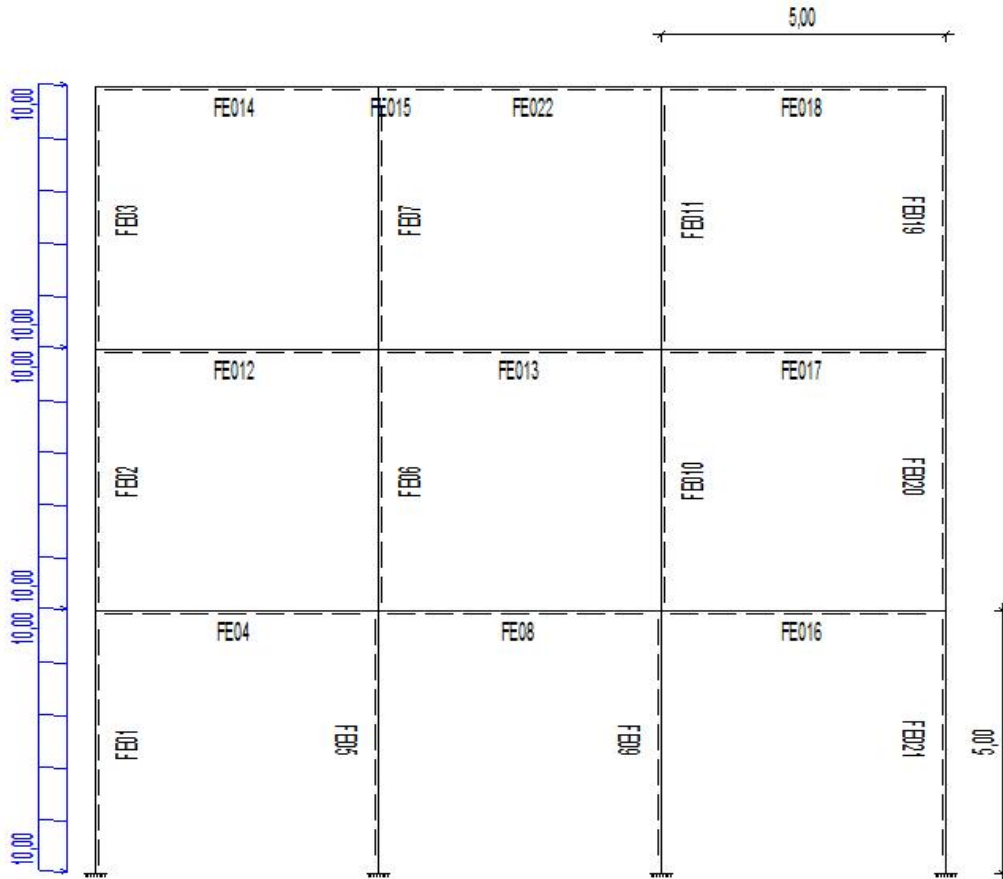
Abbildung 4.6: Stockwerksrahmen - System und Belastung
