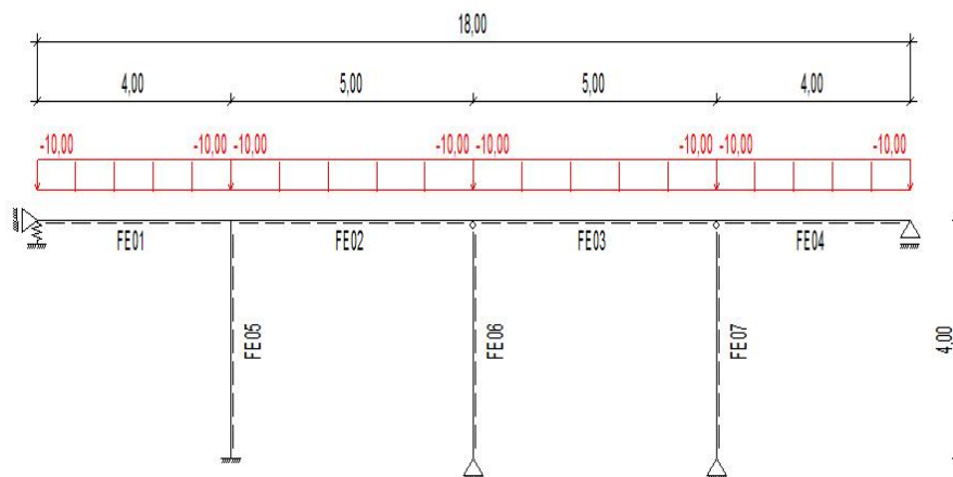
Abbildung 4.19: Mehrfeldbrücke - System und Belastung
